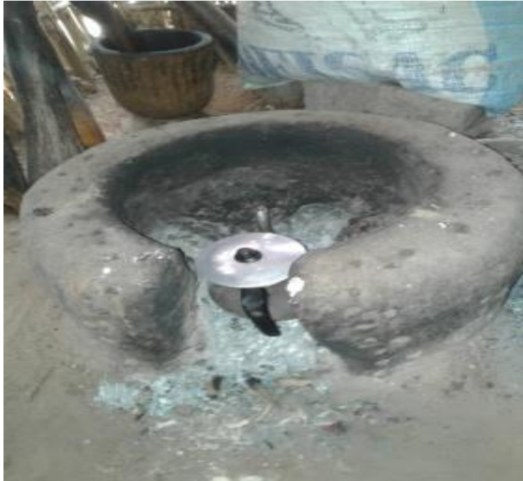
Photo 6 : Fourneau amélioré fabriqué avec la technique traditionnelle
