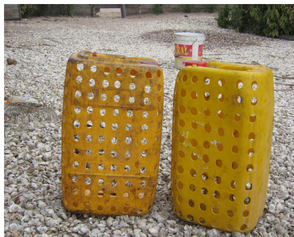
Tamis artisanaux pour le triage des coquillages, photo par O. K. SOUGOU
