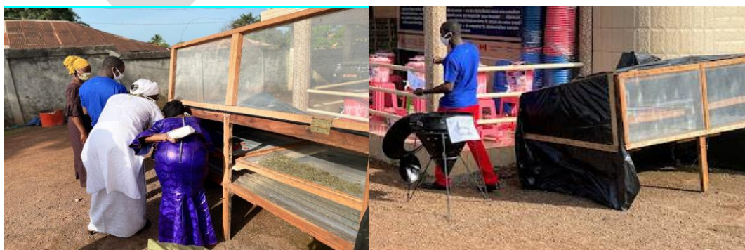
Figure 5 : Séchoir solaire pour fruits et légumes
